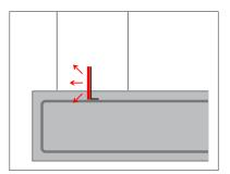
Bentonitbeschichtung zur Wasserseite hin anordnen
