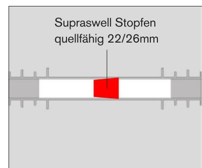
Der Weg des Wassers führt durch 10 cm hochquellfähiges Bentonit. Bentonit hat einen Durchlässigkeitsbeiwert von  $10^{-11}$  M/s d.h die Durchlässigkeit des Bentonitstreifen entspricht der von etwa 10 m Beton.
