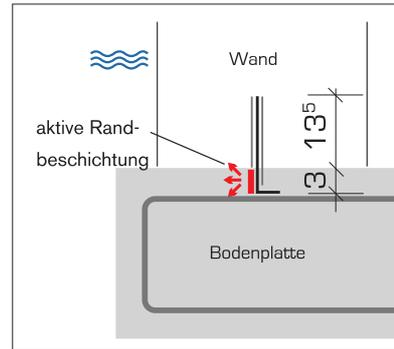
CONTAFLEX® dual sind Fugenbleche mit quellfähiger Bentonit-Randbeschichtung und beidseitiger Butyl-Klebebeschichtung. CONTAFLEX® dual wurde speziell für den Einsatz in der Fuge Bodenplatte zur aufgehenden Wand mit einer Einbindetiefe von 3 cm entwickelt. CONTAFLEX® dual Fugenbleche werden auf der oberen Bewehrungslage befestigt. Die dadurch reduzierte Einbindetiefe (3 cm) wird mit einer zusätzlichen Bentonitlage zuverlässig gesichert. Die Stoßverbindung wird als Aktivstoß ausgeführt.
