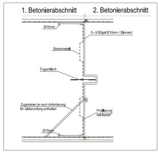
ab H = 80 cm Ausführung Z selbsttragend. Element mit oberer und unterer Bewehrung zugfest verankern
