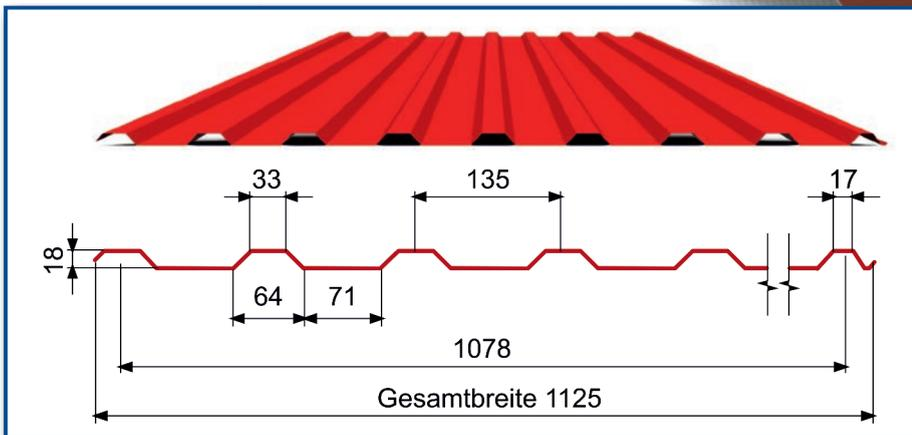
Das Trapezblech **T18 / 135** ist vorwiegend als Fassadenprofil geeignet und kann auch als nichttragendes Dachprofil verwendet werden. Das Trapezblech hat eine Breite von 1125 mm und verfügt über eine fertige **Deckbreite von 1078 mm** nach einfacher Überlappung der 18 mm hohen Hochsickenprofilierung. Die Befestigung erfolgt bei der Montage als Wandprofil in der Tiefsicke oder kann fallweise auch genietet werden.
