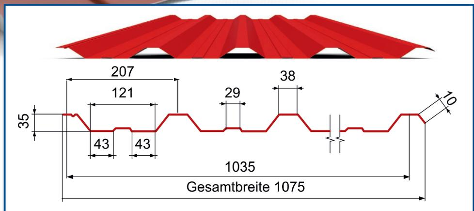
Das Trapezblech **T35 / 207** wird als Dach- und als Fassadenprofil hergestellt und kann auch als Schalung verwendet werden. Das Trapezblech hat eine Breite von 1075 mm und verfügt über eine fertige **Deckbreite von 1035 mm** nach einfacher Überlappung der 35 mm hohen Hochsicke. Die Befestigung erfolgt mit Kalotten (mit EPDM Dichtung) und selbstbohrenden Dichtschrauben an den Hochsicken. Bei der Montage als Wandprofil wird in der Tiefsicke geschraubt.
