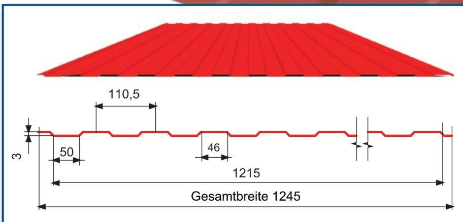
Das **Trapezblech T05 / 110,5** hat eine **Nutzbreite von 1215 mm** und wird als Fassadenblech verwendet. Es ist zur Verkleidung verschiedener Innen- und Aussenwände geeignet und soll in Hinblick auf die nur 5mm Profilierung bei der Montage an der Überlappung mit einem doppelseitigem Klebeband abgedichtet und verbunden werden (Blechbreite 1245 mm).
