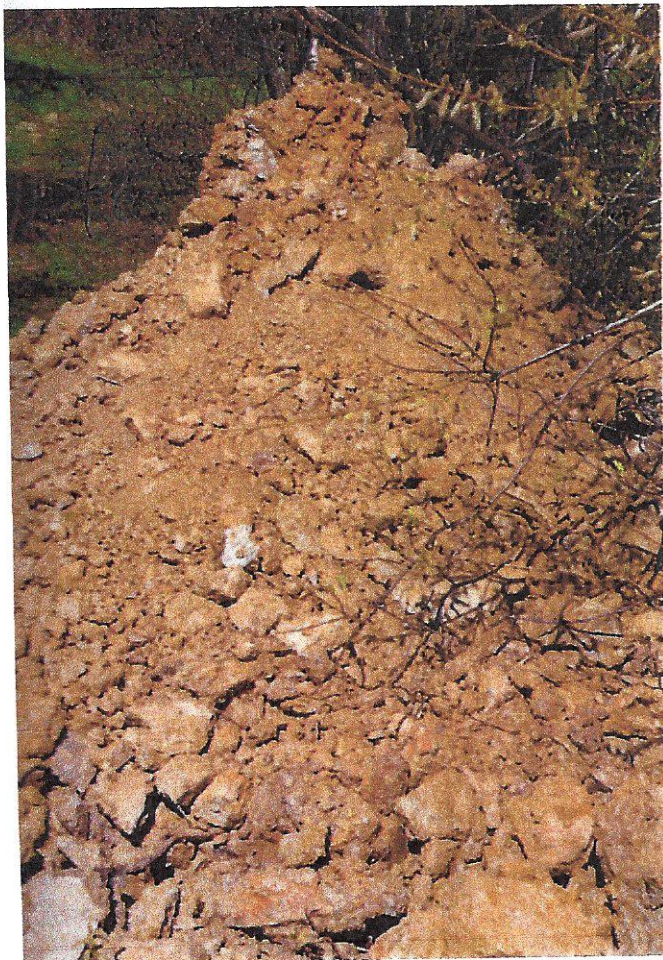
Aushubmaterial Schurf S 7, Schüttkegel
