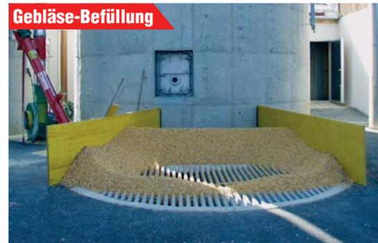
▲ Saubere, abgedeckte Schüttgrube. Förderschnecke fördert in die Steigleitung.
