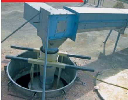
Mit Elevator oder Gebläse wird der Mais auf ein Tellerrad gefördert und an den Siloaußenrand geschleudert. Dadurch wird der Silo komplett angefüllt.
