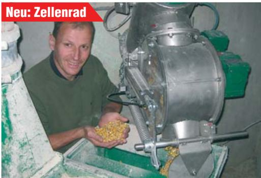
▲ Gasverlust = null Gasrückführung in den Silo ist möglich.
