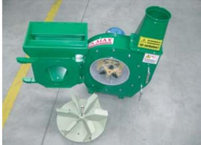
Die **Ganzkornmühle GKM** wird bei der Entnahme zum Mahlen und bei der Befüllung als Druckgebläse verwendet. Bei der Befüllung wird statt des Schlagwerkes ein Druckflügel eingebaut. Beim Mahlen kann in die Gosse gefördert werden oder man kann aus ca. 3 bis 6 m Entfernung das Material ansaugen.
