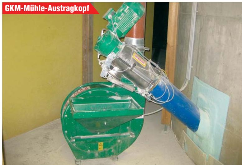
▲ Klappe mit Luftzylinder öffnen.
