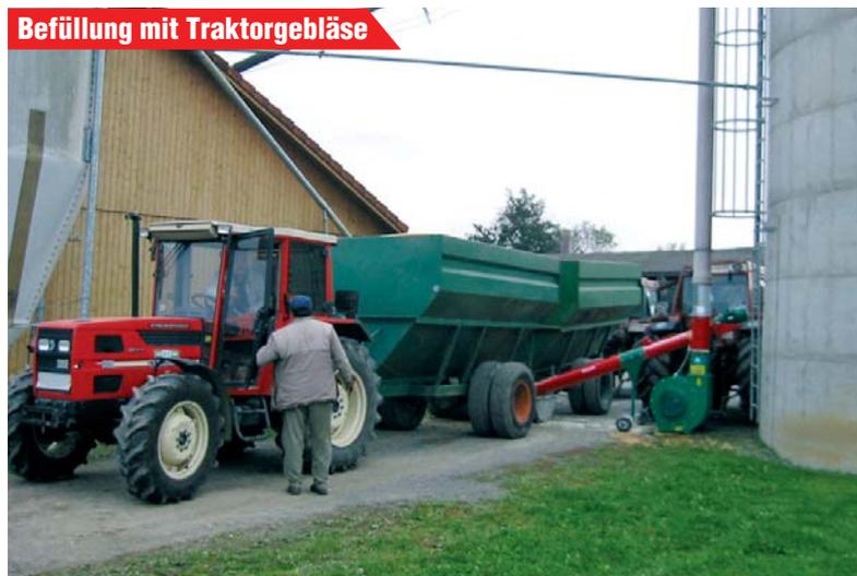
▲ Befüllmenge ist mit Schieber an der Förderschnecke einstellbar.
