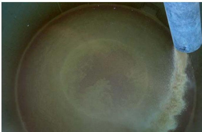
Bei größerem Silodurchmesser mit Verlängerungsrohr.
