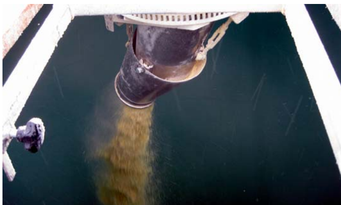
Bei kleineren Silos ohne Verlängerungsrohr.
