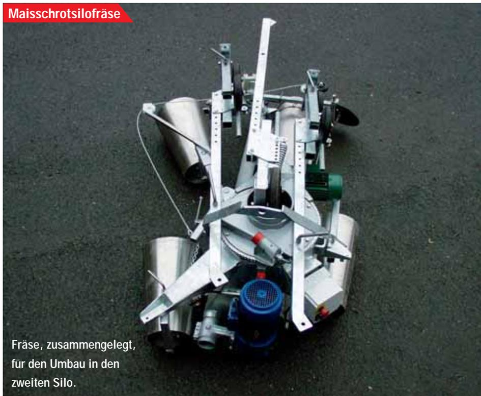
Fräse, zusammengelegt, für den Umbau in den zweiten Silo.
