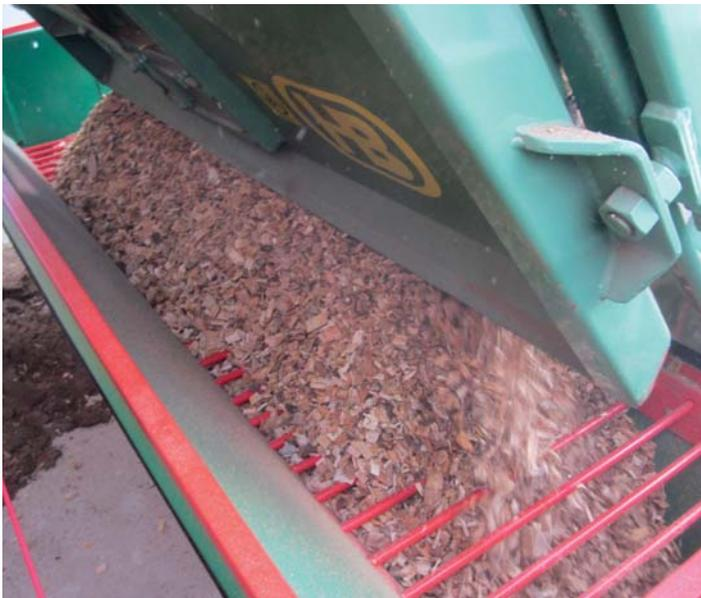
Die niedrige Bauhöhe des Trogförderers ist für alle gängigen Kipper geeignet. Durch das Wechseln der Rückwand kann der Trog von beiden Seiten befüllt werden.
