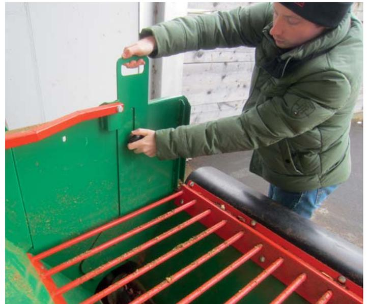
Mit einem leicht in der Höhe verstellbaren Schieber kann die Zufuhrmenge der Hackschnitzel im Fülltrog verstellt werden.
