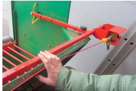
Die Förderschnecken können kurzzeitig zurückgefahren werden, damit eine Störung (Blockade) sofort behoben werden kann.
