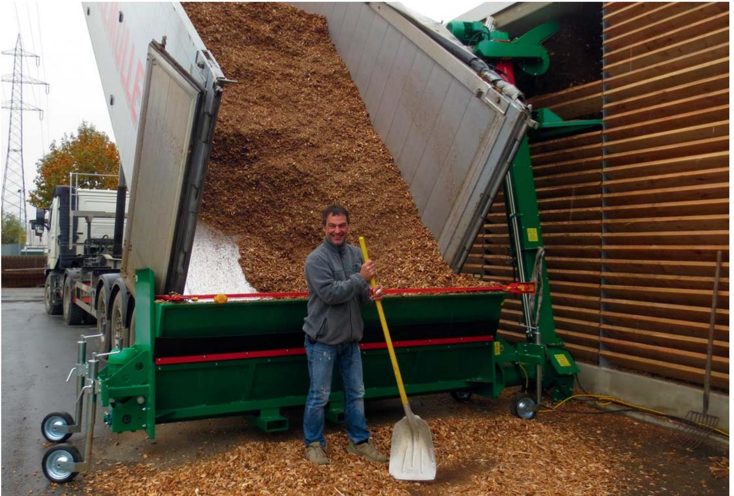
**Ein fahrbarer, 3 m langer Fülltrog mit 4 Rädern kann rasch vom Schrägförderer demontiert werden.**
