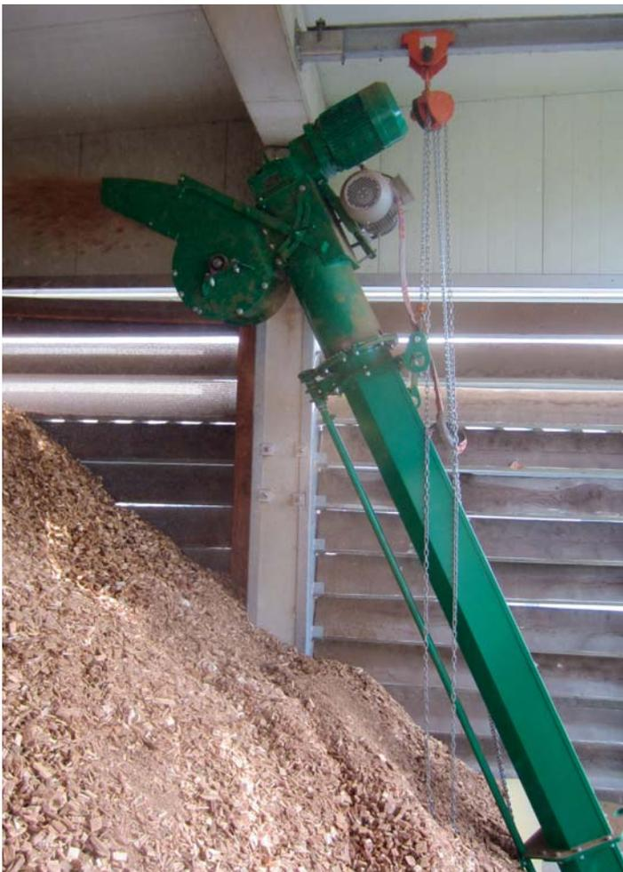
Die Schrägförderschnecke mit der Wurfeinrichtung wird oft im Lagerbunker fix montiert. Die obere Wurfeinrichtung kann mit einem Gestänge über einen Zahnkranz vom
