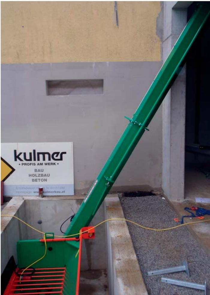
Der Hackschnitzel-Schrägförderer kann stationär in einem Betonschacht versenkt werden. Die Einfüllöffnung beim Fülltrog kann dann mit
