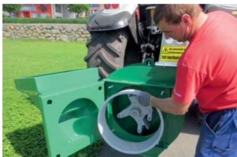
Siebwechsel: kinderleicht! Gosse öffnen, Sieb herausziehen.
