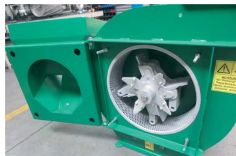
Körnerhirse können mit dem aufgebauten Messerkreuz vermahlen werden.
