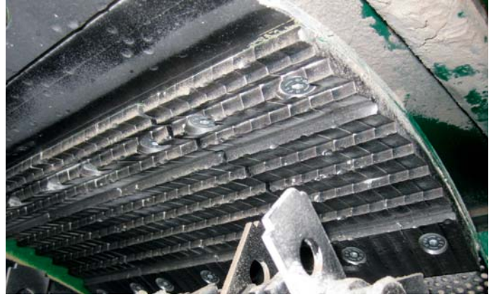
Hardox-Kornbrechblech oben sorgt für optimale Zerkleinerung (wechselbar).
