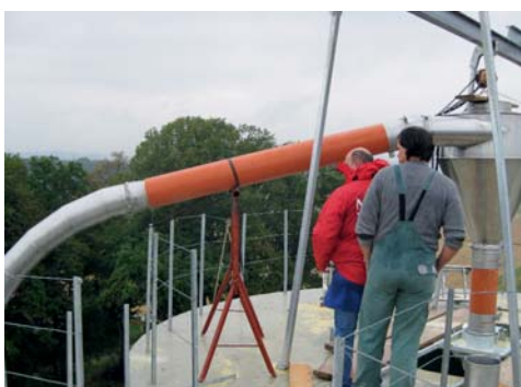
Auf der Silokrone kann mit offenem Bogen, Zyklon oder Siloverteiler die CCM-Silage in den Silo befördert werden.
