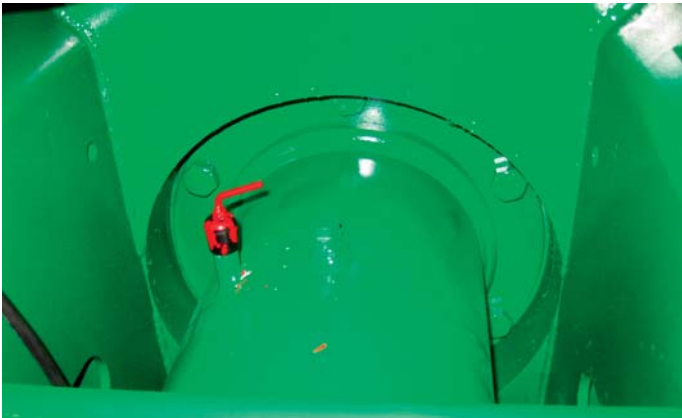
Hauptlagerung im Ölbad laufend mit herausziehbarem Ölmesstab.
