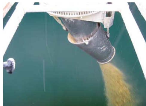
Auf der Silokrone kann mit offenem Bogen, Zyklon oder Siloverteiler die CCM-Silage in den Silo befördert werden.
