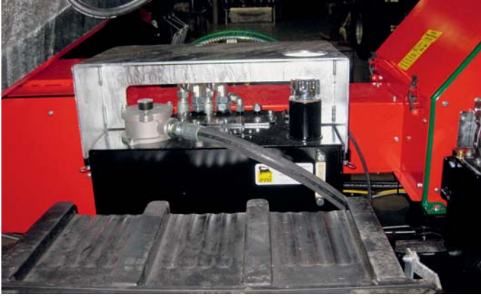
140-l-Hydrauliktank mit Rücklauffilter und Füllstandanzeige.
