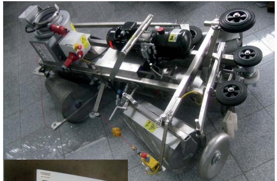
Seilzugschalter für Not-Stop-Einrichtung bei Typ HMSB 350.
