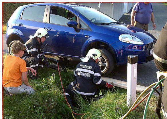
Mittels Hebekissen wurde das Fahrzeug geborgen
