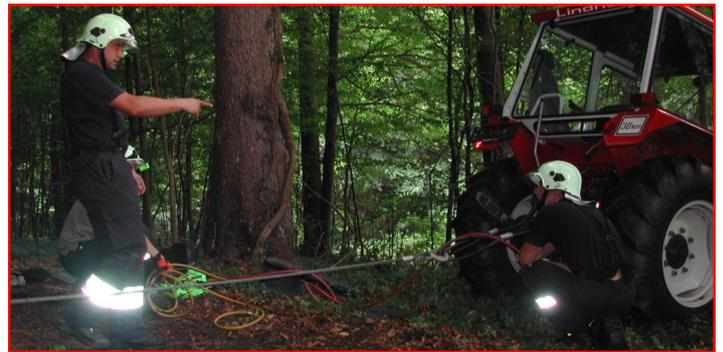
Eine technische Einsatzübung absolvierten unsere Mitglieder am 14.07.2012. Dabei galt es nach einem Unfall eine eingeklemmte Person mittels Hebekissen zu retten. Dazu musste zu zunächst der Traktor mit dem Greifzug gesichert werden, anschließend wurden die Hebekissen in Stellung gebracht, das tonnen schwere Gefährt gehoben und der Verletzte gerettet.
