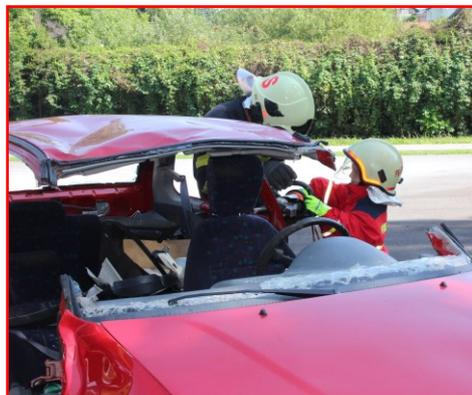
*Mit hydraulischen Rettungsgeräten wurde ein PKW zerschnitten*
